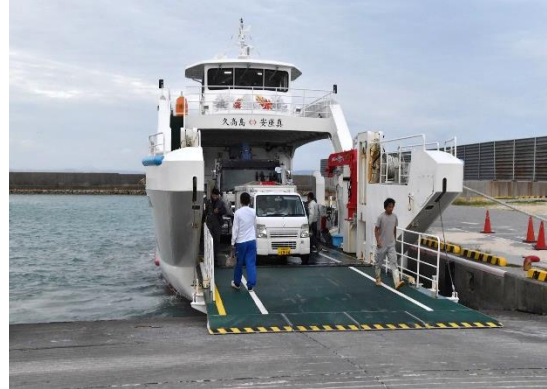
⑧ 着岸時の「フェリーくだかⅢ」です。島からの最終便だったので車も旅客もたくさん乗っていました。建造はツネイシクラフト&ファンリティーズ。89 総トンで、14 ノット。普通フェリーでは珍しいアルミ製です。
